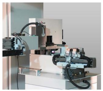
Messung der Probendicke und -breite am Querschnittsmessgerät
