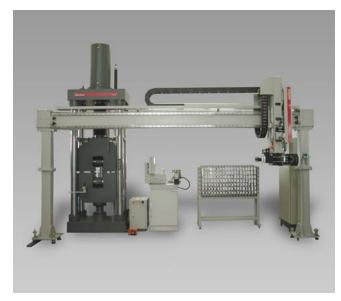
Roboter-Prüfsystem 'roboTest P'
