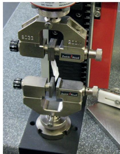
Bild 2: Prüfung der Siegelnahtfestigkeit
