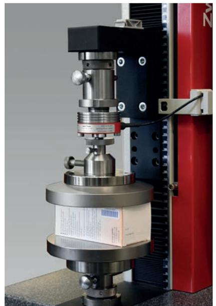
Bild 3: Box-Crush-Test an Medikamenten-Verpackungen
