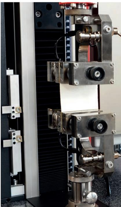
Bild 1: Zugversuch an medizinischen Textilien
