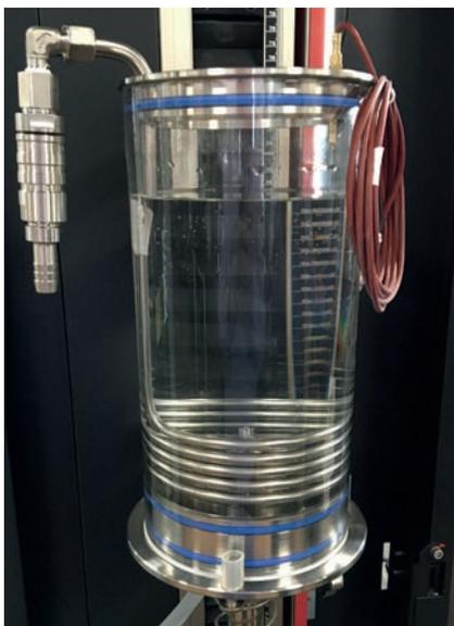
Bild 1: Mediumbehälter mit Temperiereinheit
