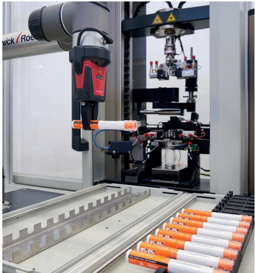
Bild 2: Prüfsystem mit vollautomatischer Probenzuführung
