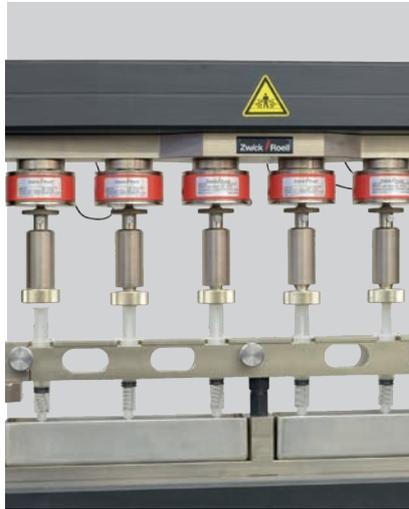
Bild 2: Parallele Prüfung von Spritzen
