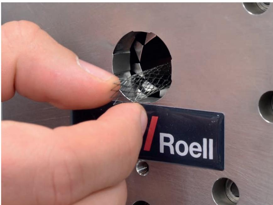
Bild 1: Radialdruckprüfung an Stents
