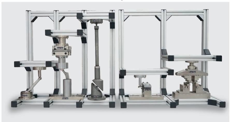
Bild 3: Unterschiedliche Probenhalter und Prüfwerkzeuge für die Biomechanik Prüfung
