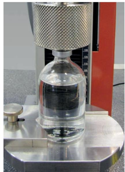
Bild 3: Ermittlung des Residual Seal Force (RSF)
