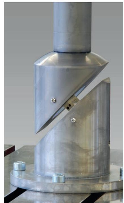
Bild 2: Torsionsprüfung an Wirbelkörperimplantat
