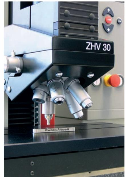
Bild 3: Härteprüfung an Dentalkeramik
