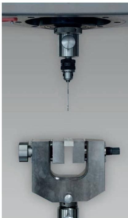
Bild 2: Eindringversuch eines Knochenbohrers
