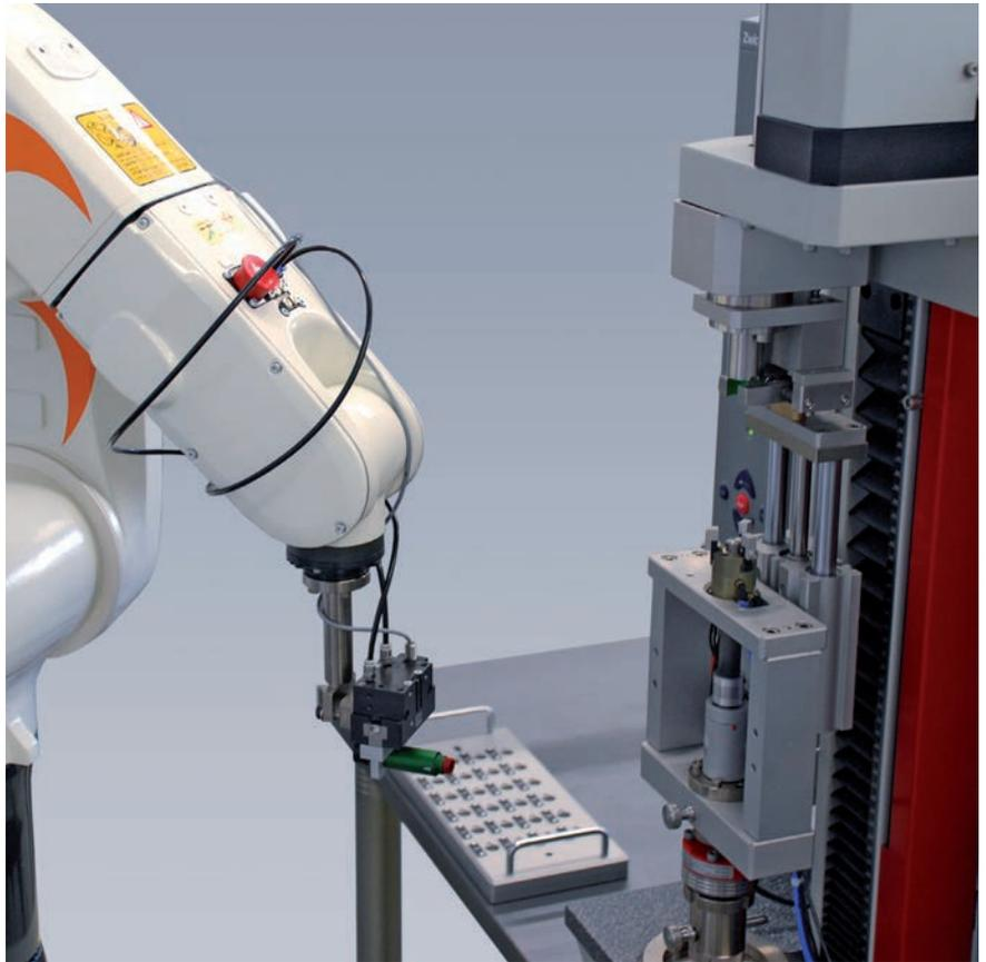
Bild 2: Vollautomatisches Prüfsystem für Insulin-Pens
