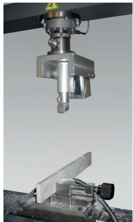
Bild 3: Druckversuch an Sagittalsägeblatt
