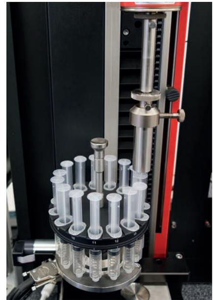
Bild 3: Semi-automatische Spritzenprüfung
