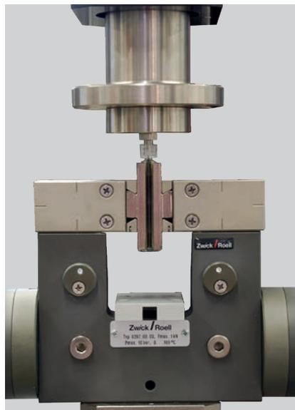
Bild 3: Prüfung von Luer-Lock Verbindungen
