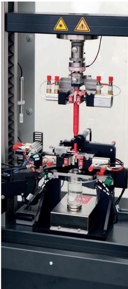
Bild 1: Multiple Prüfungen an Autoinjektoren
