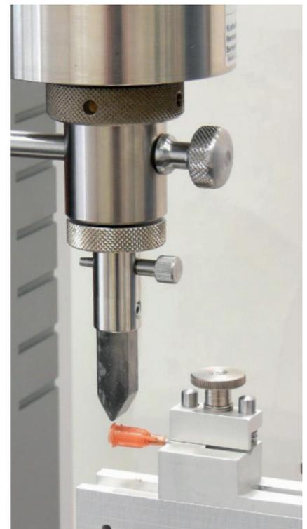
Bild 4: Biegeprüfung an Nadeln
