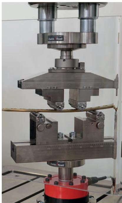
Bild 2: Biegeprüfung an Osteosyntheseplatte
