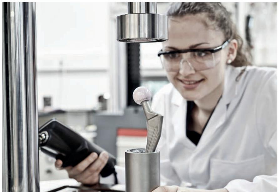
Bild 1: Ermüdungsprüfung an Hüftprothese
