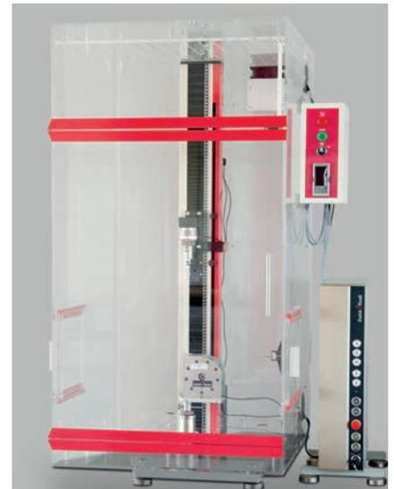
Bild 3: Temperierkammer integriert mit einer Material-Prüfmaschine
