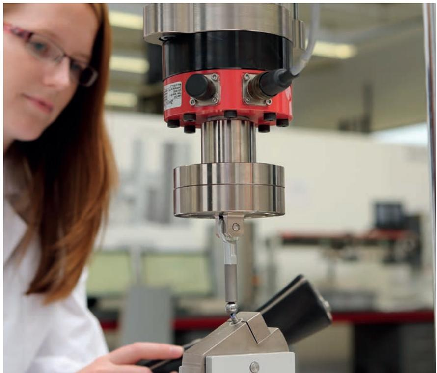
Bild 1: Ermüdungsprüfung an Dentalimplantaten
