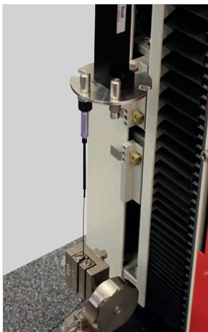
Bild 2: Zugprüfung an Kathetersystemen
