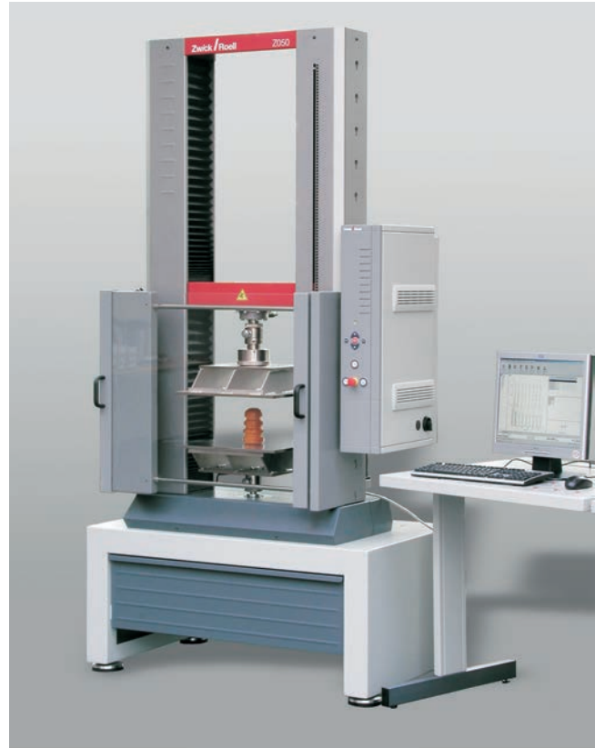
ProLine Z050 mit Druckprüfung an Formgussteilen
