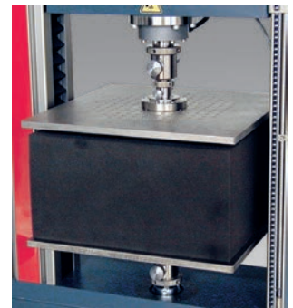
Bild 4: Schaumstoff-Prüfung mit Druckplatten 400 x 400 mm
