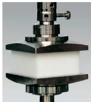
Bild 3: Schaumstoff-Prüfung mit Druckplatten 120 x 120 mm
